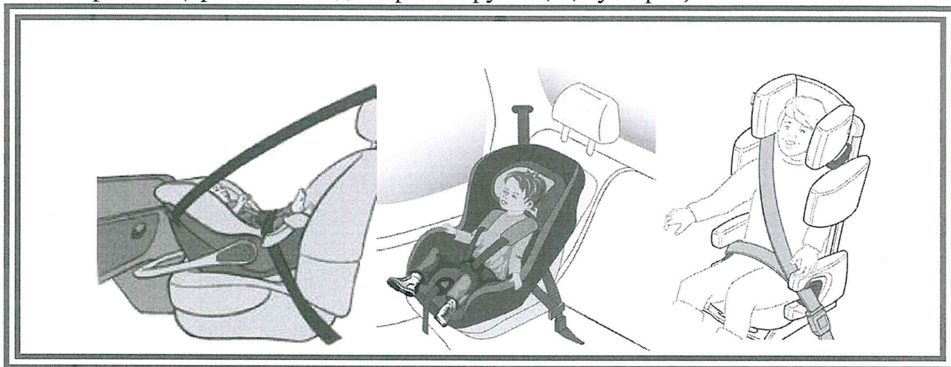
Рисунок 4. Крепление штатными ремнями безопасности
